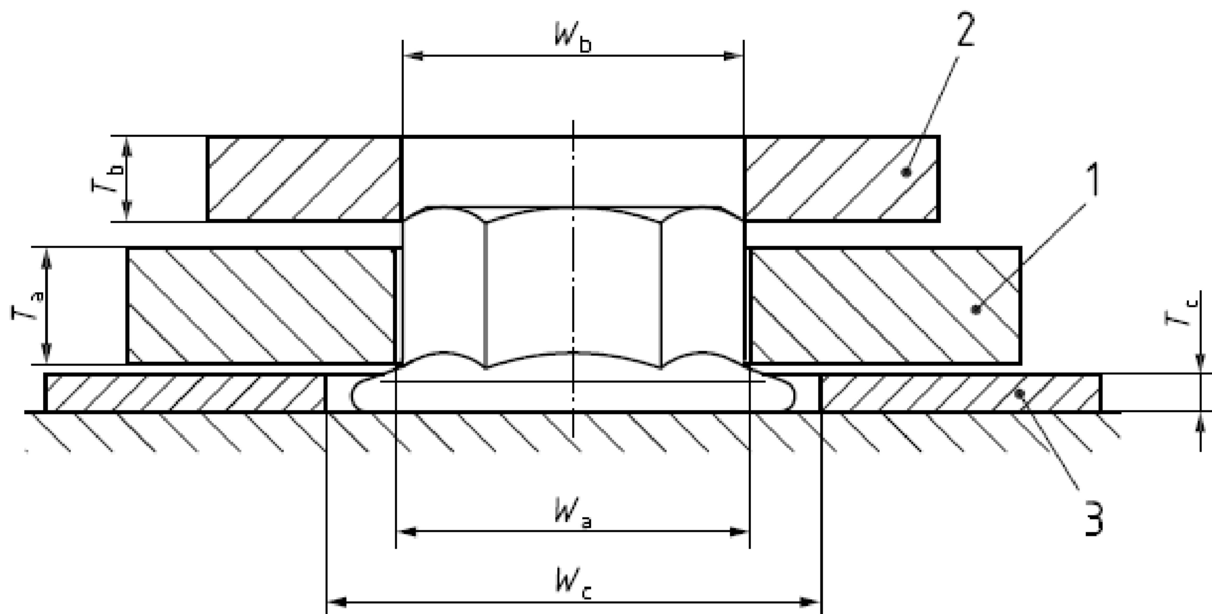
1 — калибр А; 2 — калибр В; 3 — калибр С;  $W_a$ , мин. =  $e_{\text{теор}}$ ;  $W_b$ , макс. =  $e_{\text{мин.}} - 0,01\text{мм}$ ;  $T_a$ , макс. =  $m_{w' \text{ min}}$
